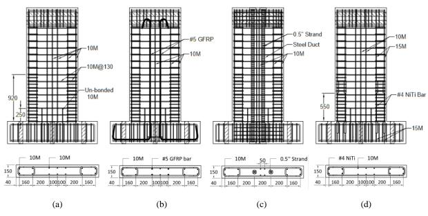
Figure 1. Reinforcement layouts of specimens: (a) CW, (b) GFRP-ECC, (c) PT-SFRC, (d) SMA-SFRC.
